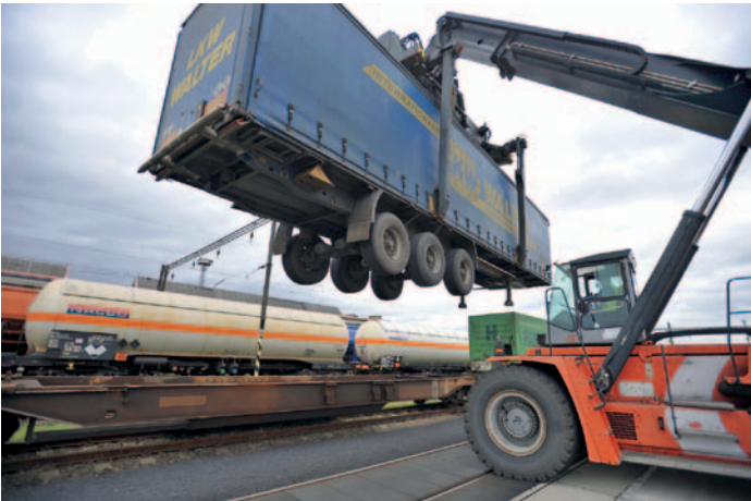
... a vloží do speciálního kapsového vagonu.
